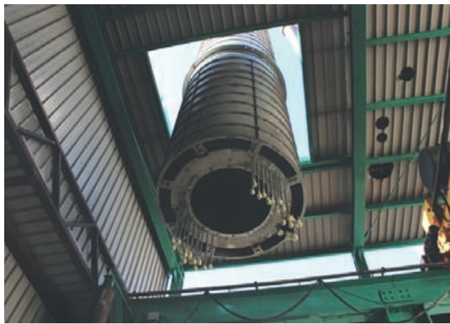
Figura 3 - Inserimento del generatore di vapore di NuScale Power all'interno del vessel del GEST
